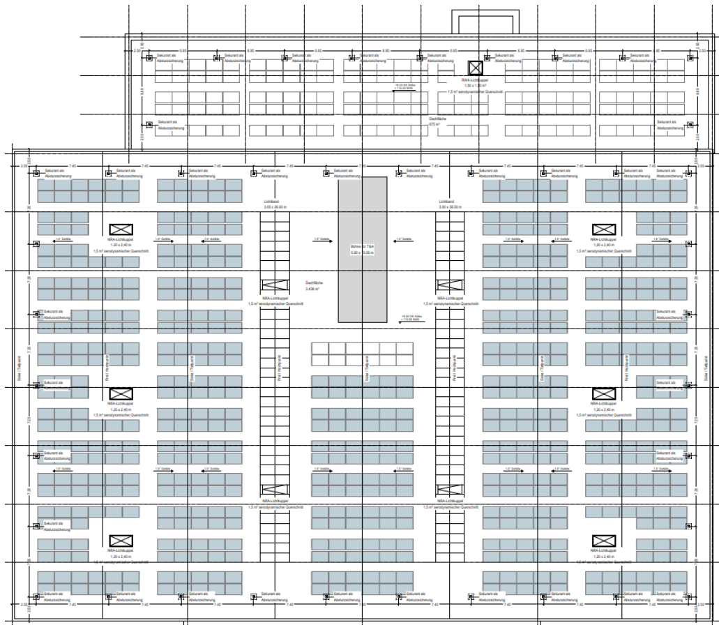
Abb. 8: Dachaufsicht mit PV-Modulen (Planstand 22.10.2024)
